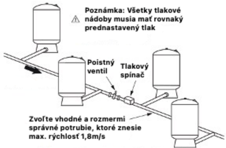
Obr. 1.5 Inštalácia viacerých tlakových nádob
