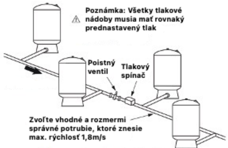
Obr. 1.5 Inštalácia viacerých tlakových nádob
