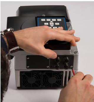
Fig. 43: Securing the M12 module
