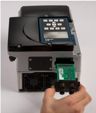
**Fig. 35:** Inserting the M12 module
