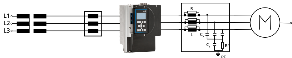
Obr. 36: Montáž síťové tlumivky a výstupního filtru
