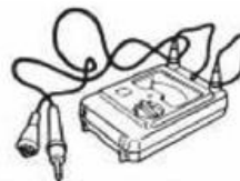
tester izolačného odporu (Megger)
