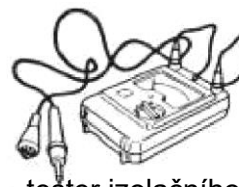
tester izolačního odporu (tester Megger)
