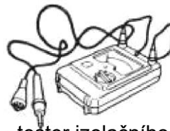
tester izolačního odporu (tester Megger)
