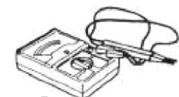
Вольтметр переменного тока
