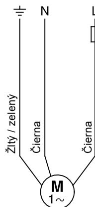
Obr. 11 Motory v prevedení s dvoma vodičmi
